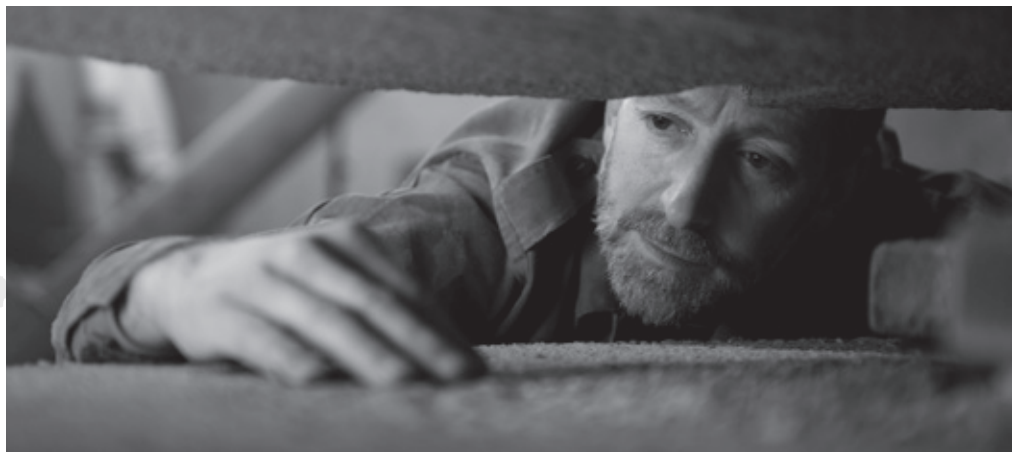
Alois kontrolliert die Schärfe des Röllsteins, Anlage Nr. 46 Ferrenmühle / Alois controlla l'affilatura della macina di rullo, installazione No 46 Ferrenmühle
