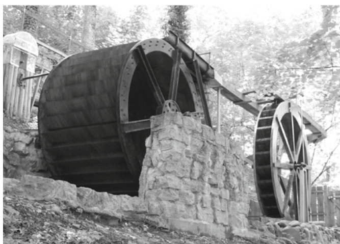
Abb. 8 Roue de Schnottwil à palettes dite « de montagne » et roue de Ferreyres à palettes dite « de plaine »
