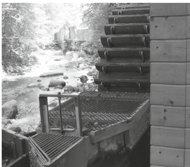
Abb. 6 Roue de Ferenbalm à palettes incurvées de type Poncelet
