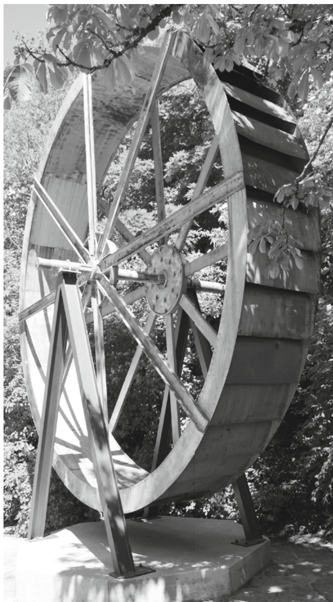
Abb. 10 Roue de Gosswil à augets par-dessus en fer, fin du XIXe s.
