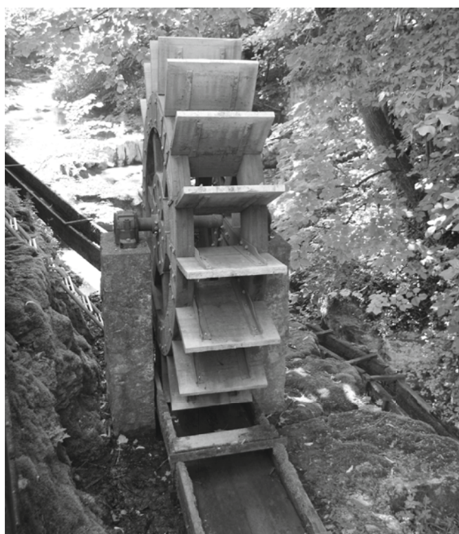
Abb. 7 Roue de Vallorbe à palettes extérieures
