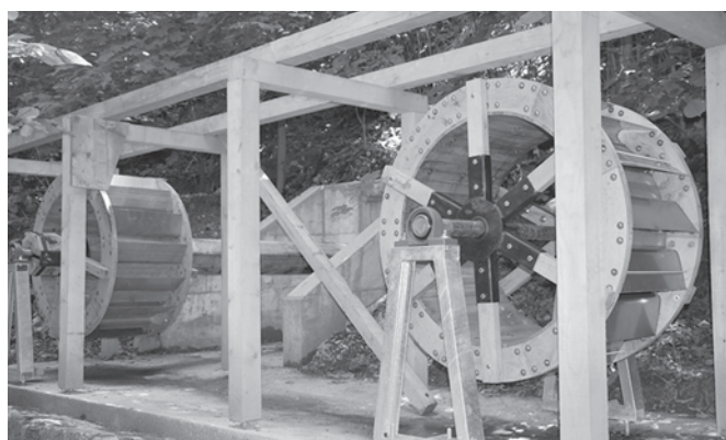
Abb. 9 Roues de Corcelles/Moutier à augets par-dessus tournant en sens inverse
