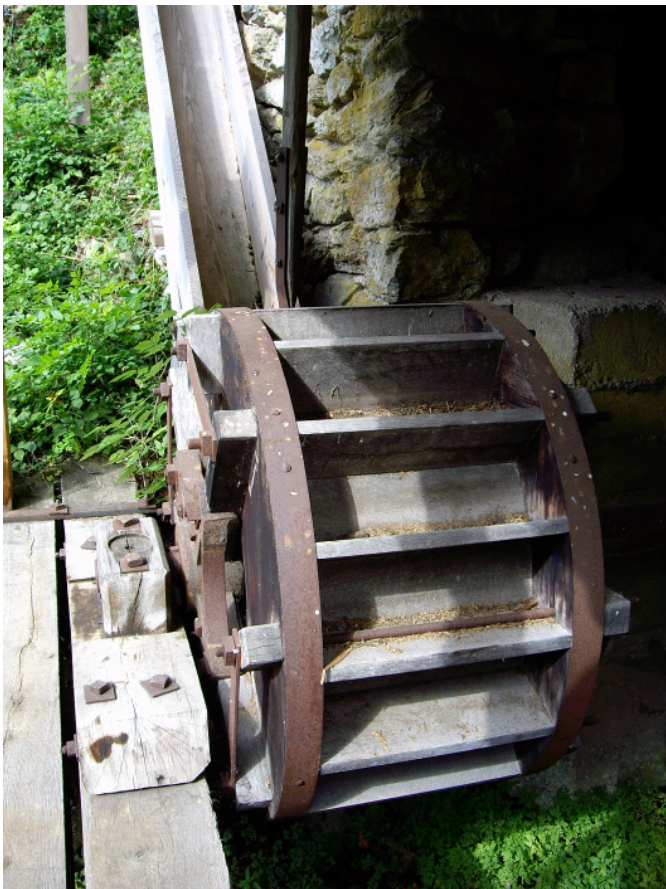
Abb. 4. Das Wasserrad, ein sog. "Waschel".
