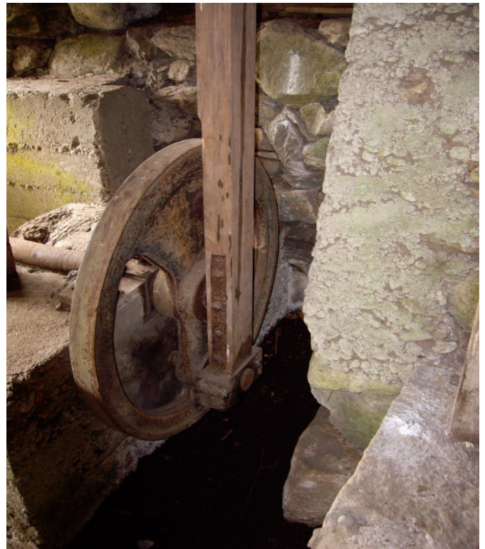
Abb. 8. Kurbelrad und Stelze.
