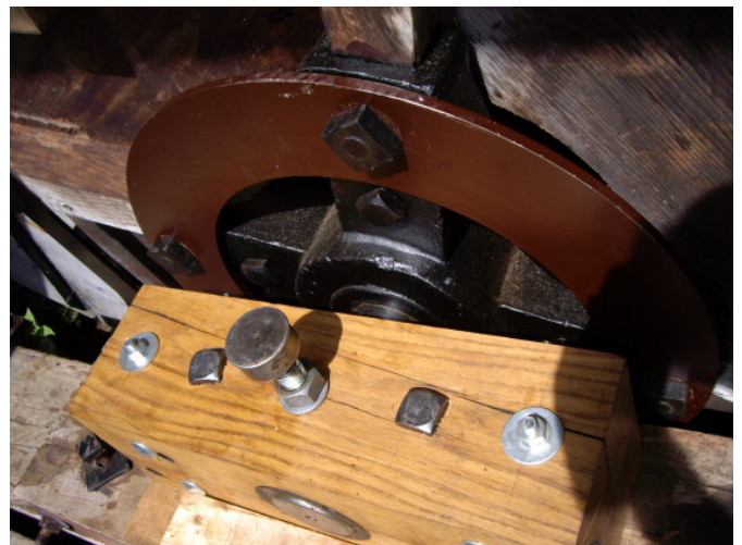
Abb. 6. Ein Eisenring verstärkt die Rosette des Wasserrades.
