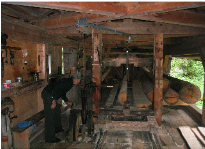
Abb. 6. Der Säger beim Einrichten der Säge zur Bestimmung der Brettstärke. Ein Arbeitsvorgang, der gelernt sein will.
