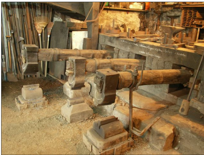
Abb. 6. Hammerschmiede mit drei Geschlägen (Mühlehorn GL).
