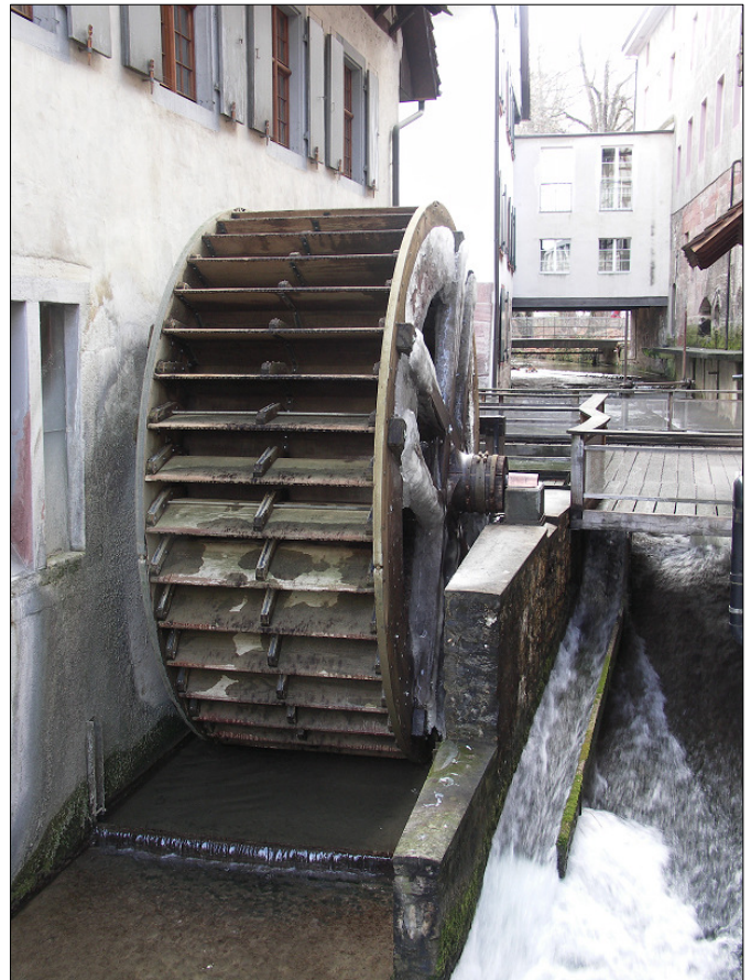
Abb. 7. Am Hinteren Teich dreht sich im St. Alban-Tal seit 1980 wieder ein Wasserrad zum Betrieb des Stampfwerkes im Schweizerischen Papiermuseum.
