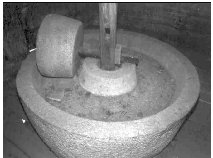
Abb. 2. Ribi mit Reibbett aus einem grossen Steinblock. Der Antrieb erfolgt direkt durch ein Horizontalwasserrad (Som-la-Proz VS).
