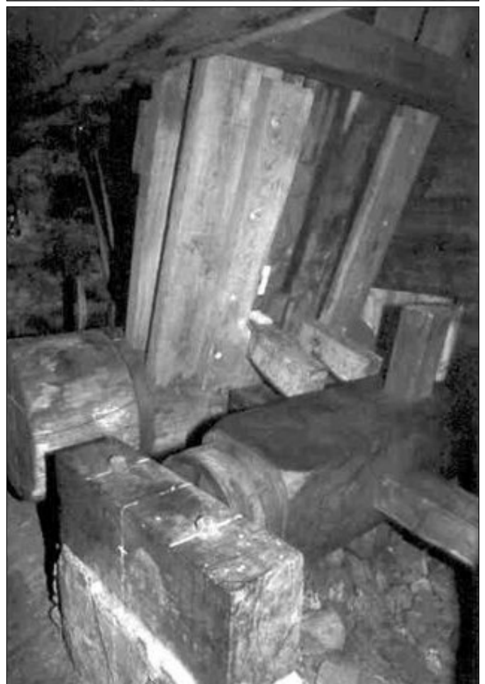
Abb. 3. Stempelwalke in Törbel VS (rechts Einbringseite, links Rückseite mit der Daumenwelle).
