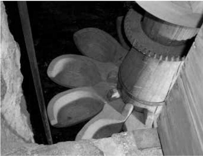
*Löffelrad der restaurierten Mulino di Frasco, Val Verzasca. Das am Wellbaum (Stock) angebrachte Kegelrad ist ein Teil des Sechskanterantriebs*
