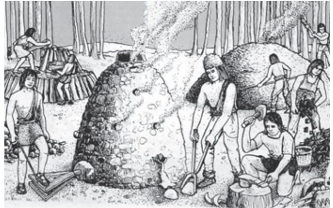
Abb. 12 Rennofen-Technologie, Herstellung von Holzkohle (im Hintergrund) und Arbeiten rund um den Schmelzofen; im Vordergrund Schmelzen der Luppe. Quelle: Dieter Schmudlach
