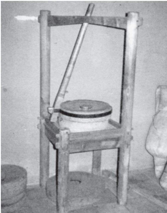
Abb. 15 Nachbau einer Römischen Kastenmühle. Gut ersichtlich ist der Schwingstab mit Führung. Augusta Raurica Foto: Berthold Moog
