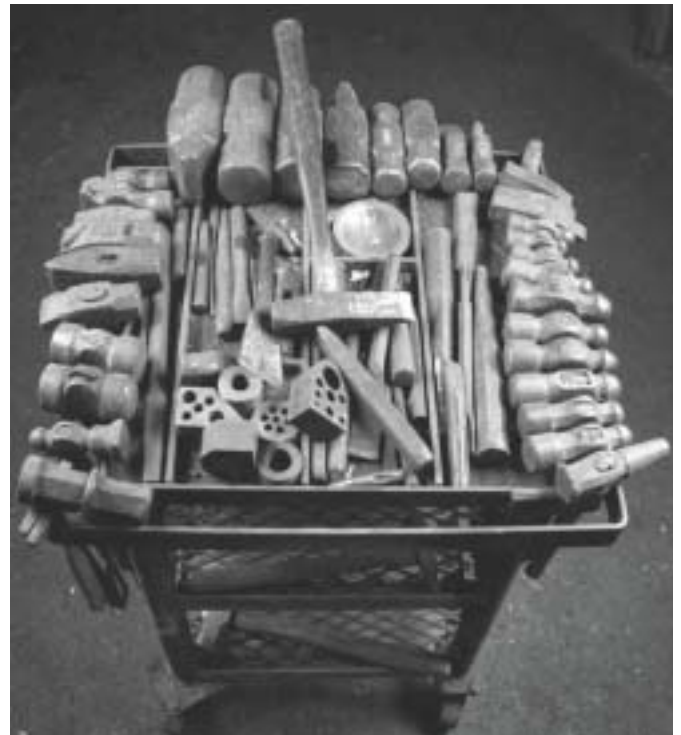
Abb. 27 Arbeitswagen mit Schmiede-, Treib- und Werkzeughämmern, verschieden Meisseln, Gesenk- und Lochwerkzeugen.
