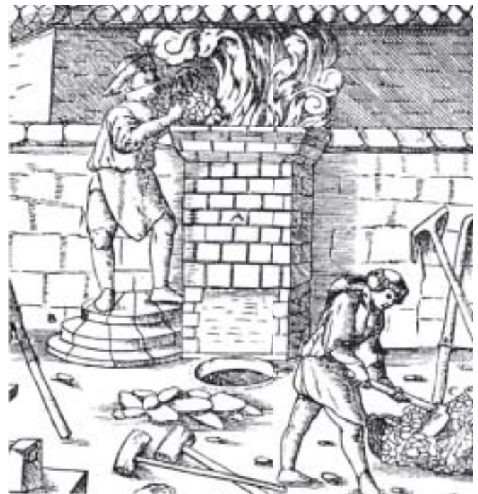
Abb. 7 Stückofen. Unten sind zwei Holzhämmer. Diese verwendeten man zum Verdichten des Eisens, dem sogenannte Gärben. Quelle: De re metallica libri XII, Agricola, 1556 (Wikicommons)
