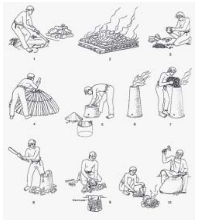
Abb. 4 1 Herausbrechen des Rasenerzbrockens 2 Röstern des Rasenerzes 3 Zerkleinern („pochen“) des gerösteten Rasenerzes 4 Holzkohleproduktion im Meiler 5 Ausheben der Schlackengrube und Aufbau des Ofenschachtes 6 Vorbrennen des Ofenschachtes; 7 Beschicken des Rennfeuerofens 8 Zerschlagen des Ofenschachtes nach Beendigung der Verhüttung 9 Herausbrechen der Luppe; 10 Reinigen und Verdichten des Eisens. Quelle: Institut für Ur- und Frühgeschichte, Kiel.
