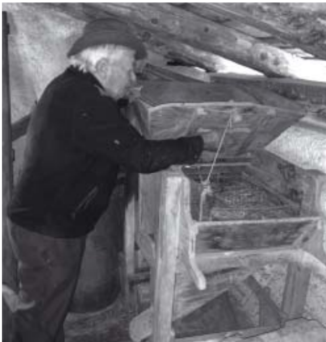
Abb. 39 Herr Daves zeigt die Funktionsweise des Kornauslesers
