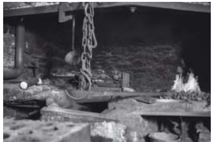
Abb. 23 Die Esse, rechts die Feuerstelle, in der Mitte unter der Kette, der Wassertrog für die Kühlung des Werkstücks.
