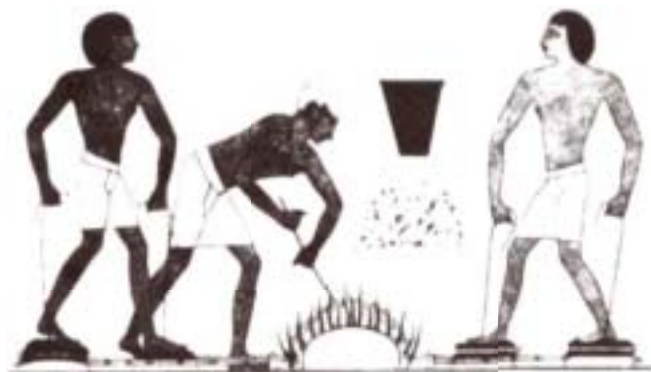
Abb. 3 Ein Bild aus ägyptischen Zeiten. Schön zu sehen sind links und rechts von der Esse zwei Männer die Tretbalgen betätigen. Diese Technologie brauchten auch die Römer bei den Feldessen.
