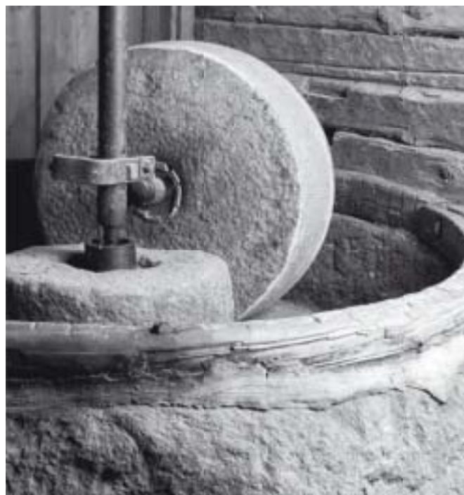
Abb. 37 Kollergang zum Obst quetschen in der Moulin Sarreyer
