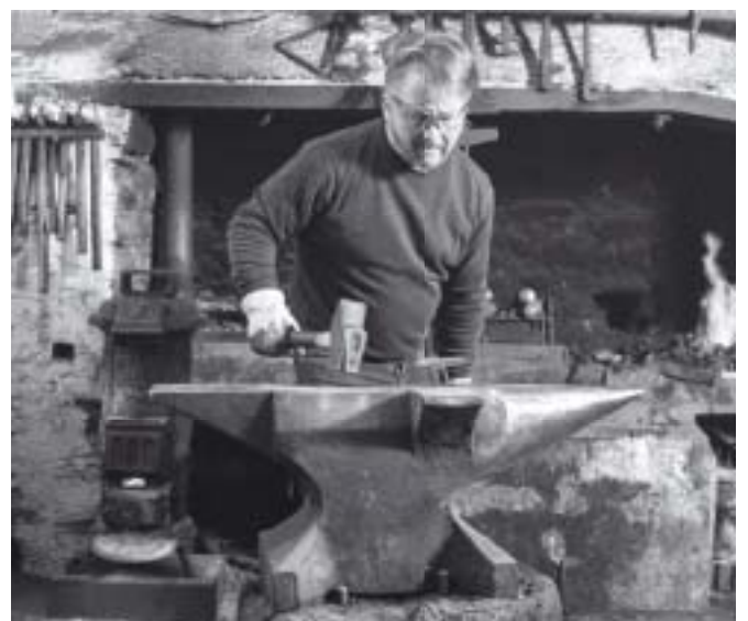
Abb. 24 Der Schmied und sein Amboss (Schweizer Form)
