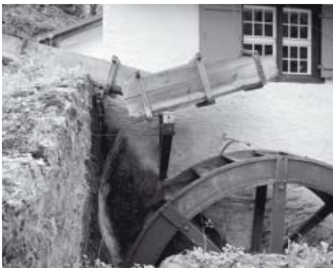
Abb. 22 Wasser vom Meerenbach; Ø 4.00 m; 0.77 m breit; 28 Schaufeln; 2x8 Speichen; 60-120 l/s. Quelle: Benjamin Thomas
