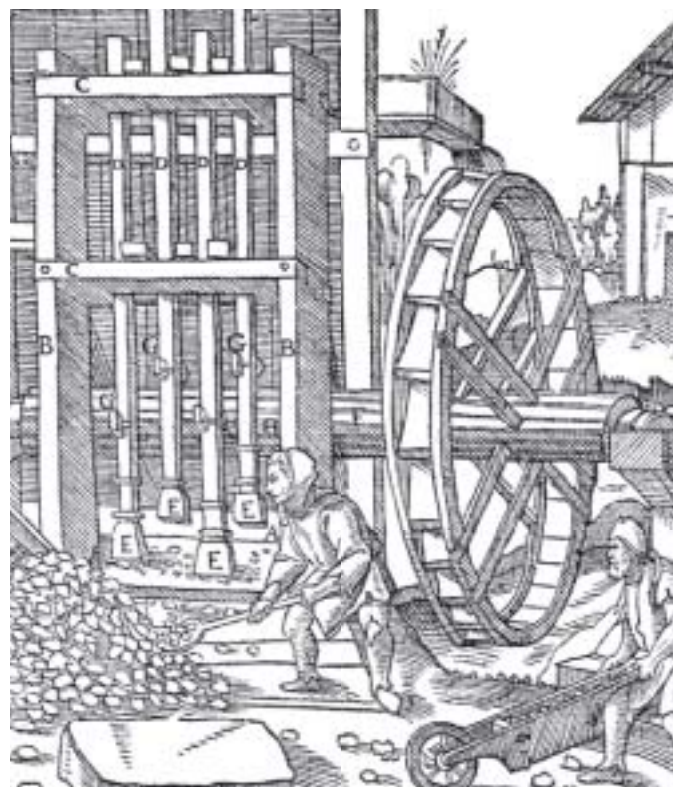
Abb. 5 A Pochtrog; B die Pochsäulen; C die Querhölzer; D die Stempel; E die Pochschuhe; F die Welle; G der Hebling; H. Der Däumling; Quelle: De Re Metallica Libri XII Georg Agricola (1556), Wikicommons
