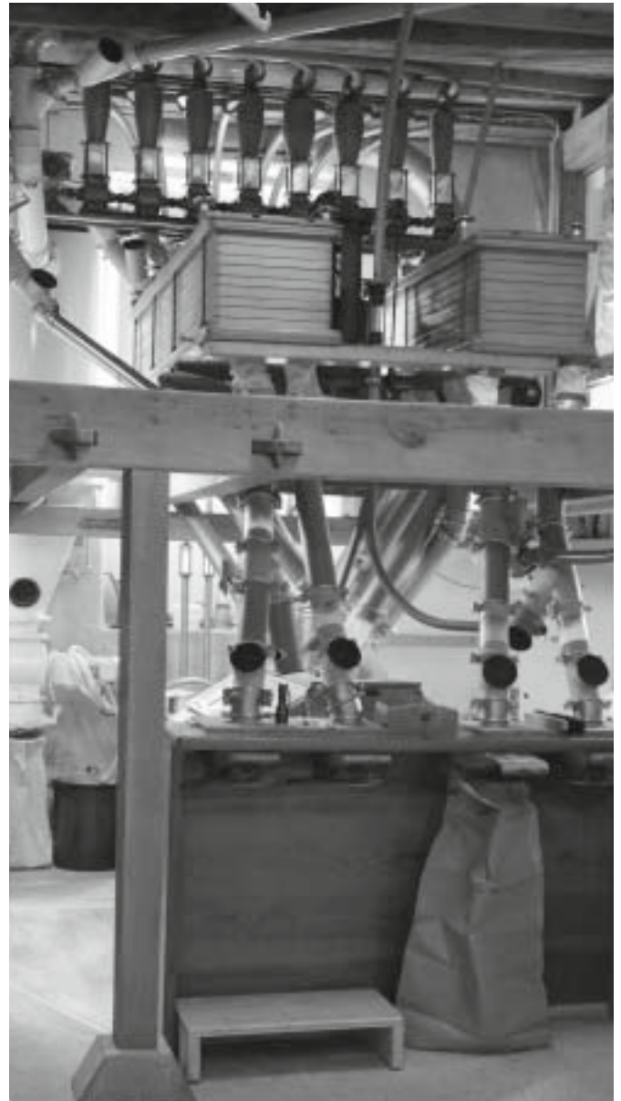
Abb. 14 Bühler (8 Passagen) Mahlstuhl mit Plansichter. Oben gut ersichtlich, die Pneumatik für das Mahlguttransport
