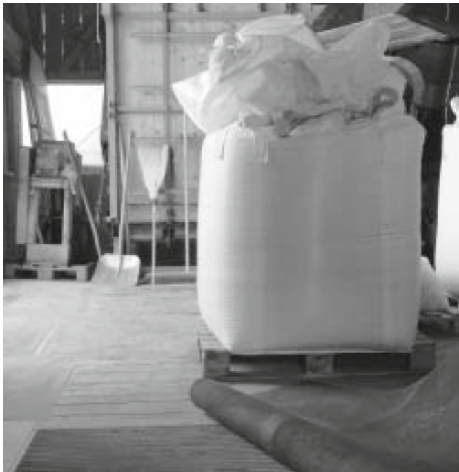
Abb. 8 Die Getreideannahme: unten der Rost, rechts ein Big Bag mit fertig geputztem Dinkel
