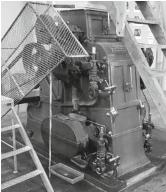
Abb. 20 Schrotwalzenstuhl, Gebrüder Seck, Dresden, gebaut um 1910. Dieser steht in der Brauerei Ruppener, Konstanz. Dieser Walzenstuhl wird für die Malzverkleinerung verwendet. Quelle: https://www.hopfenerd.ch/ruppener/
