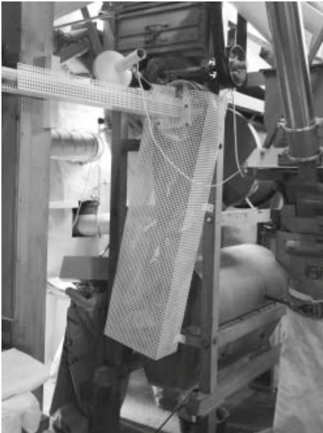
Abb. 12 Der Trieur ist hier oben und die Schälmaschine unten
