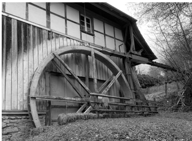
Abb. 8 Das überschlächtige Wasserrad mit 6.4 Metern Durchmesser.
