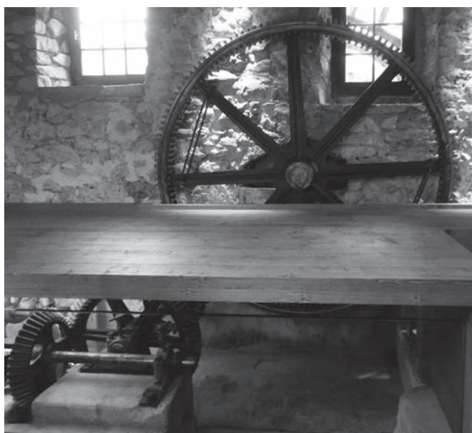
Abb. 3: Das Kammrad und das Getriebe im Innern des Mühleriums (© Mühlerama-Seon AG, Seon).
