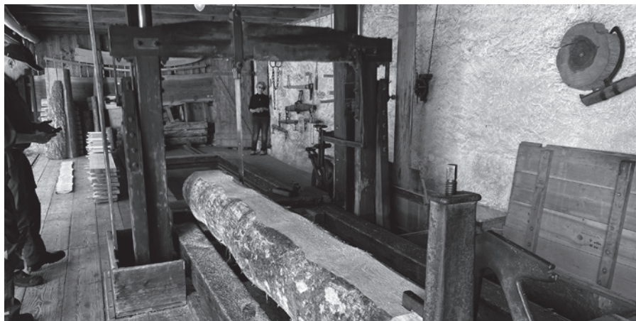
Einfachgatter der Sagi Wisental Bassersdorf, Anlage Nr. 86
