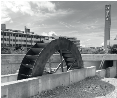
Wasserrad als Kleinkraftwerk Biel mittelschlächtiges Wasserrad Leistung 8kW, Raddurchmesser 4.4m Jahresproduktion 40'000kWh
