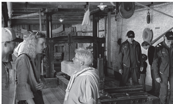
Scie à cadre simple Sagi Wisental Bassersdorf, Installation n° 86
