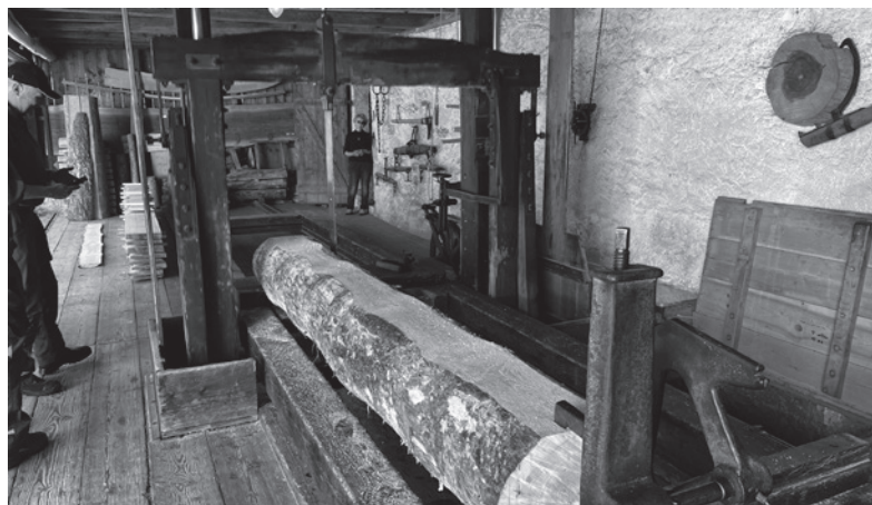
Einfachgatter der Sagi Wisental Bassersdorf, Anlage Nr. 86
