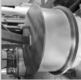
ausgeklügelter Technik entspelzt und gereinigt werden. Der Röllstein-Abstand, ca. 6 mm, muss der zu verarbeitenden Spelzfrucht angepasst werden. Entspelzte Kernen und Spreu gleiten zur Weiterverarbeitung gemeinsam zur Rendel.
